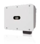
Os inversores da linha SIW500H são ideais para aplicações comerciais e industriais. Esses equipamentos possuem tecnologia de monitoramento inteligente de strings, arrefecimento por convecção natural, possibilidade de instalação ao tempo (IP65), além de seccionadora CC, supressores de surto tipo II para CC e CA e proteções contra falta a terra e corrente de fuga (DR). Além também de trazerem a tecnologia AFCI.
